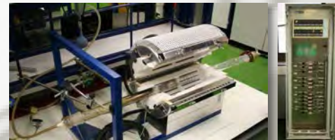
Reactor tubular para síntesis de grafeno mediante CVD
